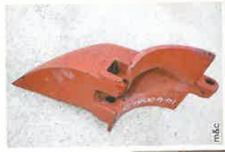
Dent neuve à monter sur un des deux rotors. Ce sizer est équipé de 48 dents : 24 par arbre pour 6 rangées de 4 dents sur chacune d'entre elles.
