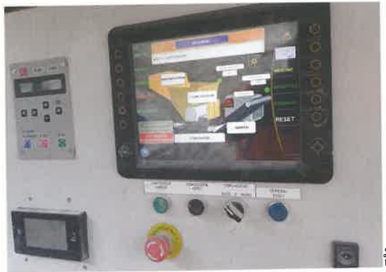
Sur l'IHM du sizer mobile, c'est le chauffeur de la chargeuse qui règle la vitesse de l'ATM, la vitesse du convoyeur de sortie des matériaux, et la vitesse de rotation du sizer. La vitesse relativement lente des rotors et la taille des dents facilitent le traitement des matériaux humides et collants (des peignes de nettoyage évitent l'amoncellement de matériaux collants sur les arbres).
